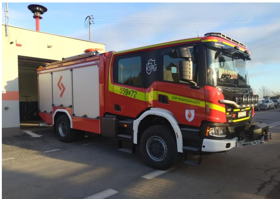
Zdjęcie: nowy ciężki samochód ratowniczo – gaśniczy typu GCBA 5/37, marki SCANIA P370 XT.
